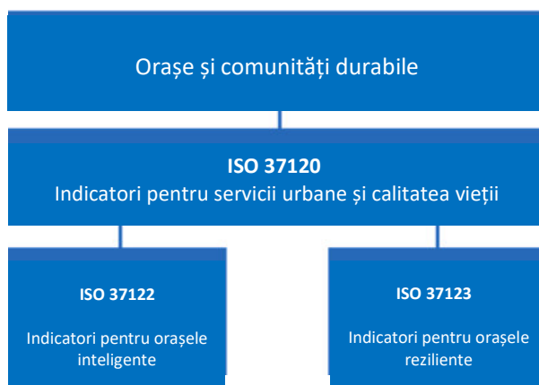
Figura 2.10.6. Orașe și comunități durabile – Relații în cadrul familiei de standarde privind dezvoltarea urbană
