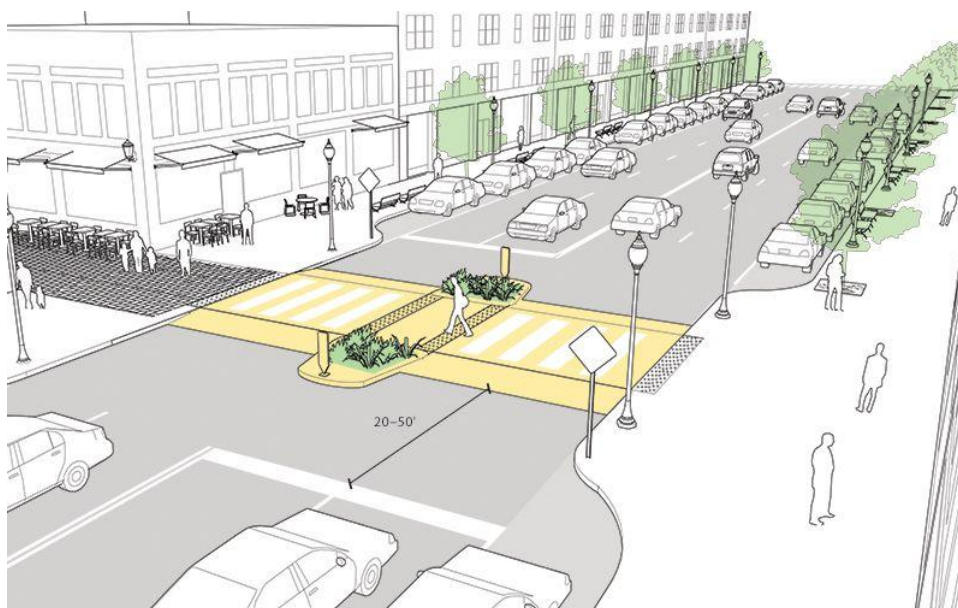
Figura 2.5.67. Traversări mediane – Propunere de ridicare a cotei carosabilului la cea a trotuarului
